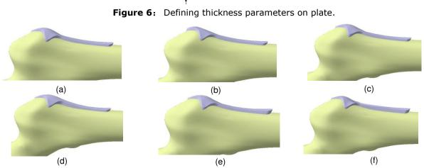
**Figure 7:** Plates with different thickness: (a)  $H_1=2mm H_2=2mm H_3=2mm H_4=2mm H_5=2mm$ , (b) $H_1=3mm H_2=2mm H_3=2mm H_4=2mm H_5=2mm$ , (c)  $H_1=2mm H_2=3mm H_3=2mm H_4=2mm H_5=2mm$ , (d)  $H_1=2mm H_2=2mm H_3=2mm H_4=3mm H_5=2mm$ , (e)  $H_1=2mm H_2=2mm H_3=2mm H_4=3mm H_5=3mm$ , (f)  $H_1=2mm H_2=3mm H_3=3mm H_4=3mm H_5=3mm$ .
