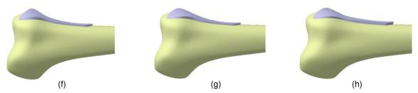
**Figure12:** Parameterization of III type of plate and plates with different thickness: (d)  $H_1=2mm$   $H_2=2mm$   $H_3=2mm$   $H_4=2mm$   $H_5=2mm$ , (e) $H_1=3mm$   $H_2=2mm$   $H_3=2mm$   $H_4=2mm$   $H_5=2mm$ , (f)  $H_1=2mm$   $H_2=3mm$   $H_3=2mm$   $H_4=2mm$   $H_5=2mm$ , (g)  $H_1=2mm$   $H_2=2mm$   $H_3=3mm$   $H_4=2mm$   $H_5=2mm$ , (h)  $H_1=2mm$   $H_2=2mm$   $H_3=2mm$   $H_4=3mm$   $H_5=3mm$ .
