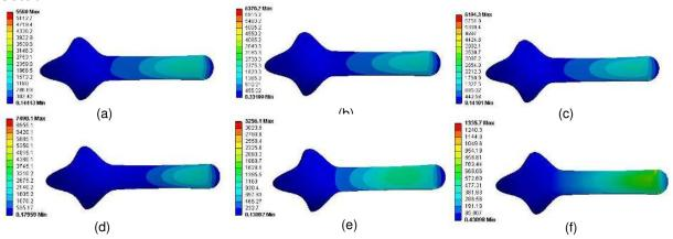
**Figure 8:** Analysis of plates with different thickness: (a)  $H_1=2mm H_2=2mm H_3=2mm H_4=2mm H_5=2mm$ , (b) $H_1=3mm H_2=2mm H_3=2mm H_4=2mm H_5=2mm$ , (c)  $H_1=2mm H_2=3mm H_3=2mm H_4=3mm H_5=2mm$ , (d)  $H_1=2mm H_2=2mm H_3=2mm H_4=3mm H_5=2mm$ , (e)  $H_1=2mm H_2=2mm H_3=2mm H_4=3mm H_4=3mm H_5=3mm$ , (f)  $H_1=2mm H_2=3mm H_3=3mm H_4=3mm H_5=3mm$ .
