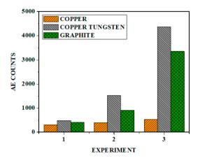
Fig. 5. (d) AE counts comparison for copper, copper tungsten and graphite
